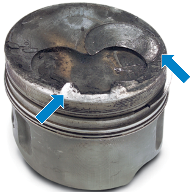
Rys. 4: ślady powstałe na skutek przegrzania silnika
